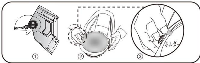
図のようにヘルメットバンドのホルダーをヘルメットのつばの端にしっかりとはめ込んで取り付けてください。(図③)
