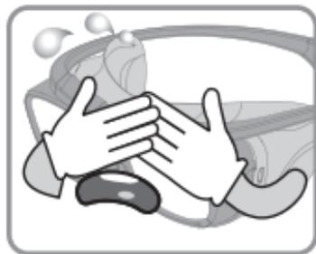
光センサーに異物が付着したり、光センサーがアーク光から隠れないようにしてください。
