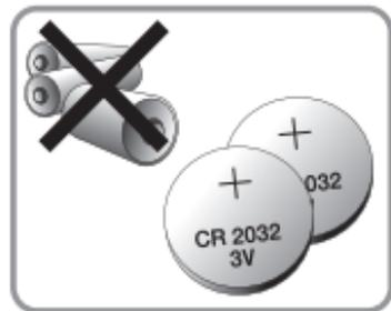
リチウム電池は、CR 2032/3Vを2個、同履歴のものを使用してください。
